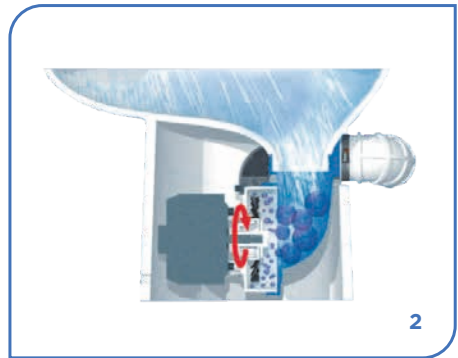
Absaugen und Zerkleinern
